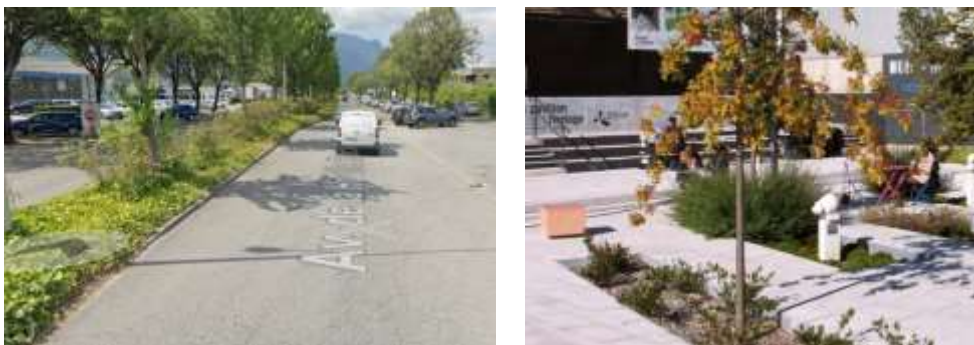
Exemples de modes de gestion des eaux pluviales opposés : à gauche, les eaux pluviales n'alimentent pas les sols ni les végétaux, à droite si
